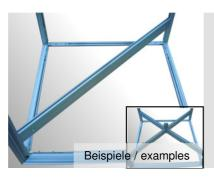
Beim Kubus über 2,5 Meter Seitenlänge wird die mitgelieferte Stützstrebe zentriert eingesetzt. Die Stützstrebe wird mittels eines Torxschlüssels T30 mit Spannschlössern im Rahmen fixiert.
