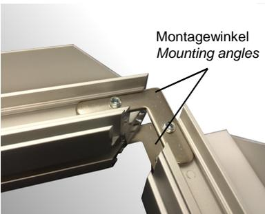
Die acht Eckwinkel werden zunächst in zwei gleichlange Rahmenprofile (jeweils zwei) seitlich in die dafür vorgesehenen Profilkammern eingeschoben. Mittels Imbusspanner (Sechskantschraubendreher) werden die Profilrahmen an allen vier Ecken passgenau zusammengefügt und verschraubt.
