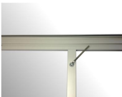
Beim Slim Frame „25“ über 2,5 Meter Länge wird die mitgelieferte Stützstrebe zentriert eingesetzt. Die Stützstrebe wird mittels eines Torxschlüssels T30 mit Spannschlössern im Rahmen fixiert.
