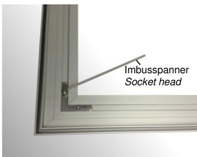
Mittels Imbusspanner (Sechskantschraubendreher) werden die Profilrahmen an allen vier Ecken passgenau zusammengefügt und verschraubt.
