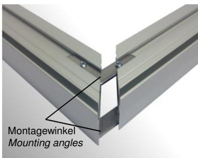
Die acht Eckwinkel werden zunächst in zwei gleichlange Rahmenprofile (jeweils zwei) seitlich in die dafür vorgesehenen Profilkammern eingeschoben. Ebenso werden die weiteren Profileile auf die Montagewinkel aufgeschoben.
