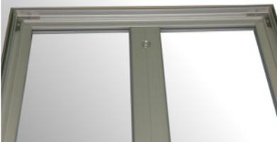
Beim Slim Frame „45“ über 2,5 Meter Länge wird die mitgelieferte Stützstrebe zentriert eingesetzt. Die Stützstrebe wird mittels eines Torxschlüssels T30 mit Spannschlössern im Rahmen fixiert.
