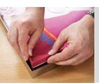
An einer Ecke beginnend drehen Sie die angenähte Gummileiste mit beiden Händen um 90 Grad nach innen. Die Gummileiste ist somit nicht mehr erkennbar. Jetzt setzen Sie diese in den SlimO-Frame "35" Rahmen ein.
