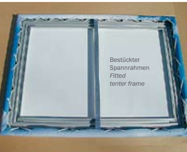
Längs- und Querseite abwechselnd spannen. Tension the longitudinal and lateral sides alternately.
